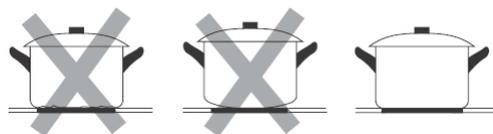
S'assurer que le diamètre des récipients est adapté au diamètre du foyer et qu'il est bien positionné au centre.
