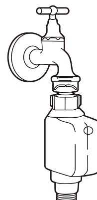
tuyau d'arrivée d'eau de sécurité
