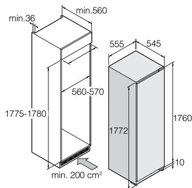
Dimensions de l'appareil et d'encastrement
